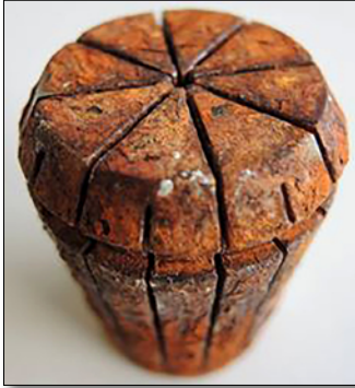
Standard ER-Spannzange / Material: herkömmlicher Federstahl
