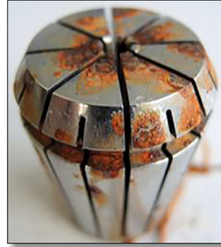
Rostfreie ER-Spannzange eines Mitbewerbers (DE) / Material: DIN 1.4034
