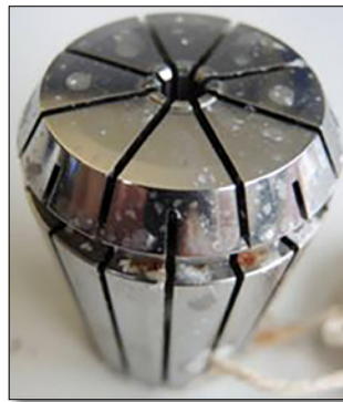
REGO-FIX rostfreie ER-Spannzange / Material: DIN 1.4122
