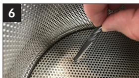
6 Dégraisser la tige de l'outil. Le meilleur moyen est d'immerger l'outil dans un liquide propre et dissolvant la graisse (par exemple de l'alcool, un nettoyant à froid, etc.).
