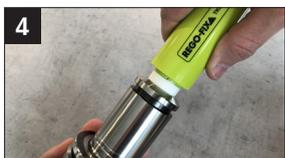
4 Insérez complètement le nettoyeur de cône dans le porte-outil. Nettoyez l'interface powRgrip sur le porte-outil avec un mouvement de rotation.
