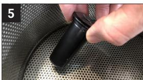
5 Dégraisser la pince de serrage. Le meilleur moyen est d'immerger l'outil dans un liquide propre et dissolvant la graisse (par exemple de l'alcool, un nettoyant à froid, etc.).
