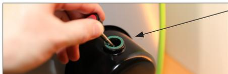
Insérer la jauge d'huile dans l'orifice de remplissage et la visser
