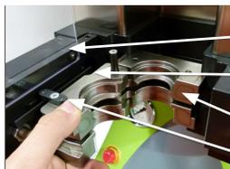
A Insérer les adaptateurs de serrage APG 906, APG 910, APG 915, APG 925 ou APG 932 dans l'unité de serrage powRgrip®, en plaçant la bride de guidage (D) dans le rail de guidage (B) sur la porte de fermeture (A) et en introduisant l'adaptateur de serrage (C) dans le guidage de la machine.
