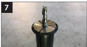
7 Séchez le mandrin de la pince de serrage. N'utilisez de l'air comprimé que s'il est propre et sans huile. Insérez l'outil dans la pince de serrage.
