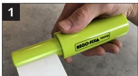
1 Insérez le papier de nettoyage par l'avant dans la fente du cône de nettoyage, poussez-le à fond vers l'arrière et alignez le début du papier au ras de la fente opposée.
